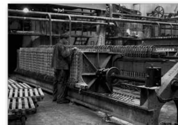
4 Pracownik obsługujący tzw. osadniki mydła – specjalne prasy, na których następuje chłodzenia mydła, fot. PAP/CAF Worker operating the so-called soap sedimentation tanks – special presses where the soap is chilled, photo: PAP/CAF
